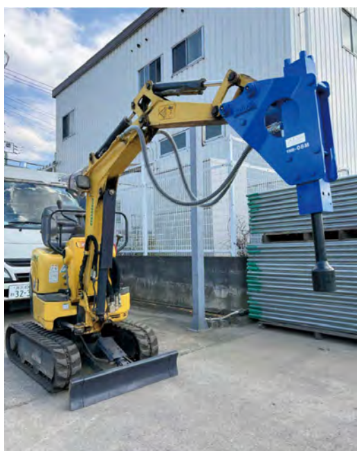
■TNB-08M杭打ちチゼル (0.03後方配管BH) (単管パイプ等の打込)
