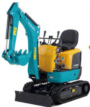
U008 注：レンタル機は配管付
