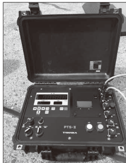
■指示計 ケース閉時は防水構造(IP67)、パネル面は防滴構造です。
