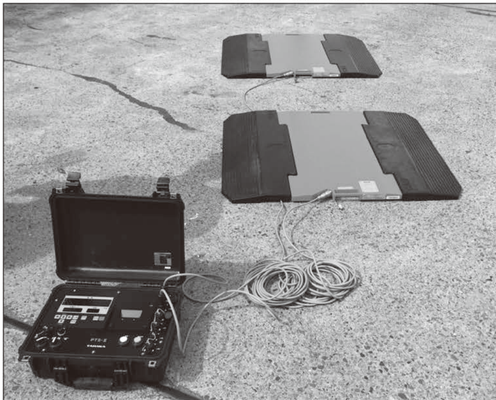
■指示計 ケース閉時は防水構造(IP67)、パネル面は防滴構造です。
