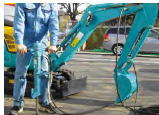
U-008 配管口から油圧を取り出します。
