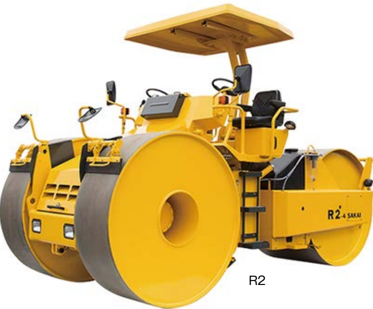
■作業員に機械の接近を知らせるラインライト 大型ローラーには標準装備
