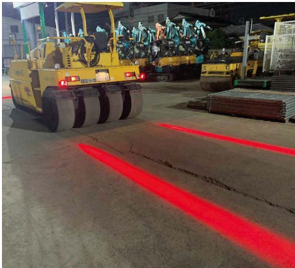
■作業員に機械の接近を知らせるラインライト 大型ローラーには標準装備
