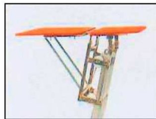
●荷台の反転 はしごの最上部に荷台が到達すると背板が自動的に反転し、後側からの荷物の取り込みが用意にできます。(最大積載荷重120kg)
