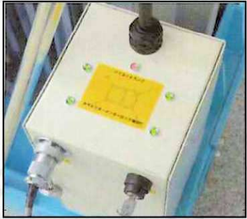
■適切にアウトリガーが張られていないと上昇しないアウトリガーインターロック機構付き。
