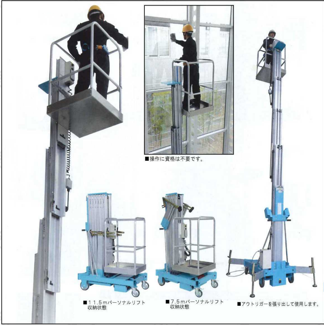
■適切にアウトリガーが張られていないと上昇しないアウトリガーインターロック機構付き。
