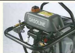
作業者への負担を軽減し、作業効率を高める防振ハンドル
