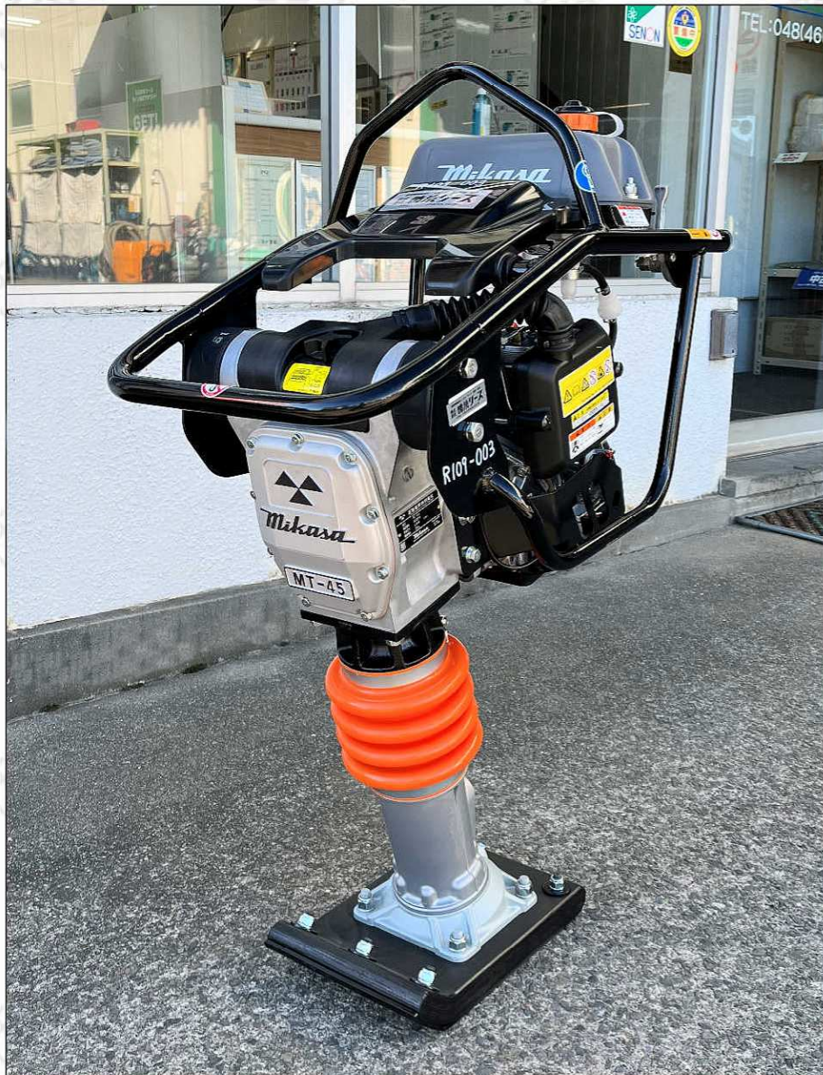
作業者への負担を軽減し、作業効率を高める防振ハンドル
