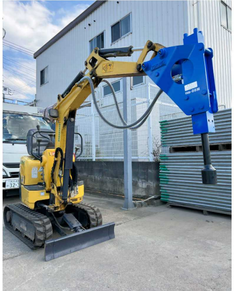
■0.03用杭打ちチゼル
