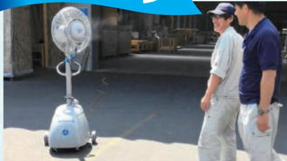
気化熱で周囲を冷却。ノズルタイプで目詰まりなし
